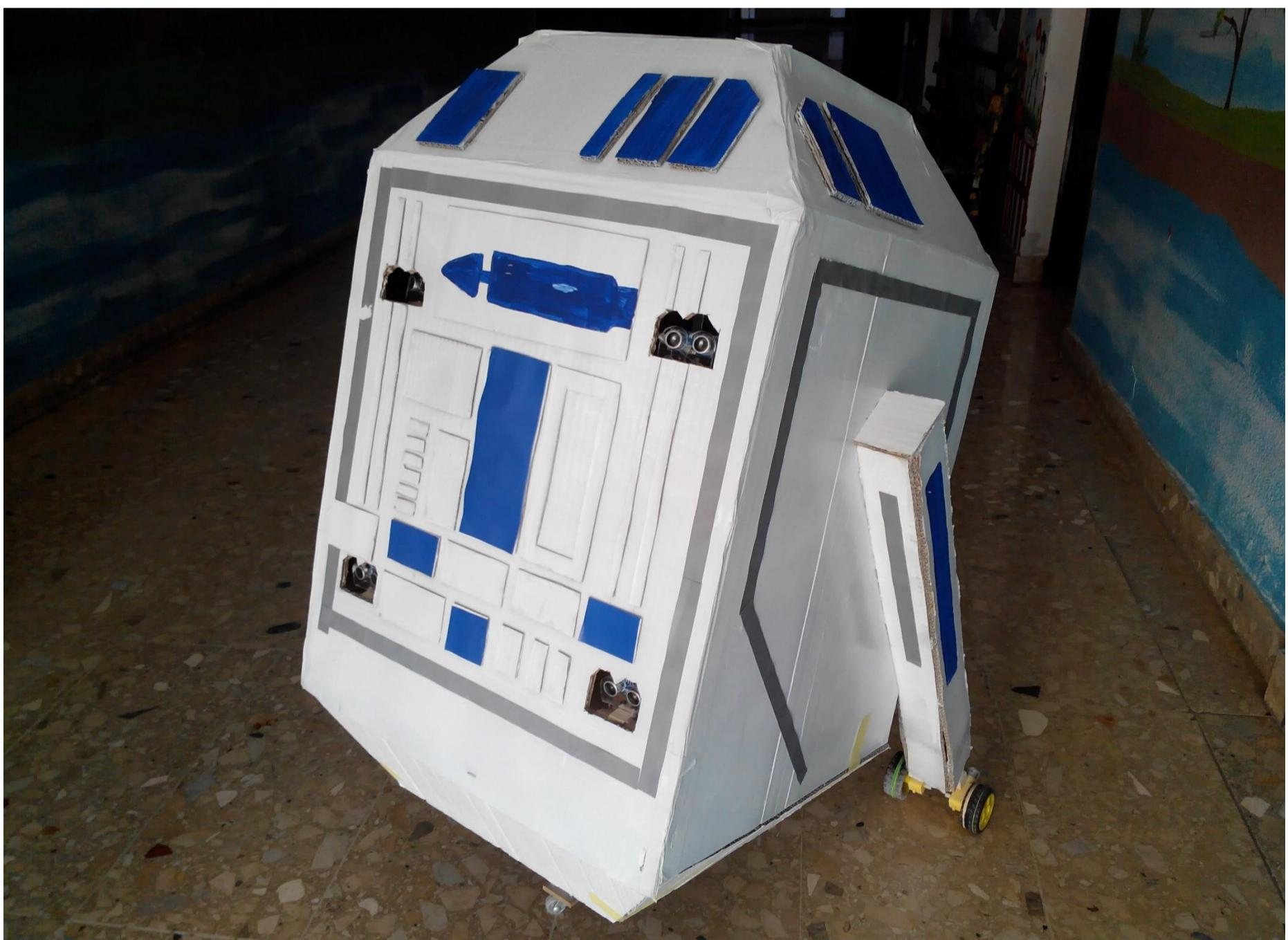
Za izradu korišteno: Arduino Uno R3, dc motori s prijenosom, kotači, L298N motor driver, ultrazvučni senzori, zvučnik, spojne žice, 18650 baterije, kućište za baterije, konstrukcija i oplošje robota
