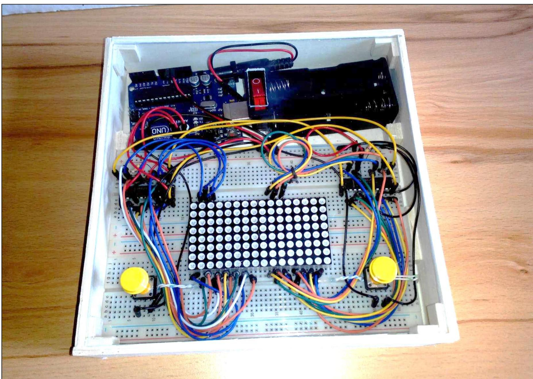
Za izradu korišteno: Arduino Uno R3, 8x8 led matrica, max7219 led driver, mikroprekidač, eksperimentalna pločica, spojne žice, kućište, 18650 baterije, kućište za baterije
